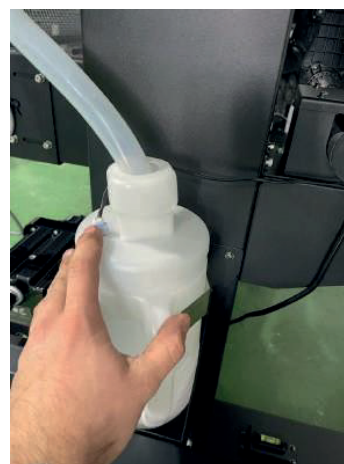
Bote residual con sensorde nivel
